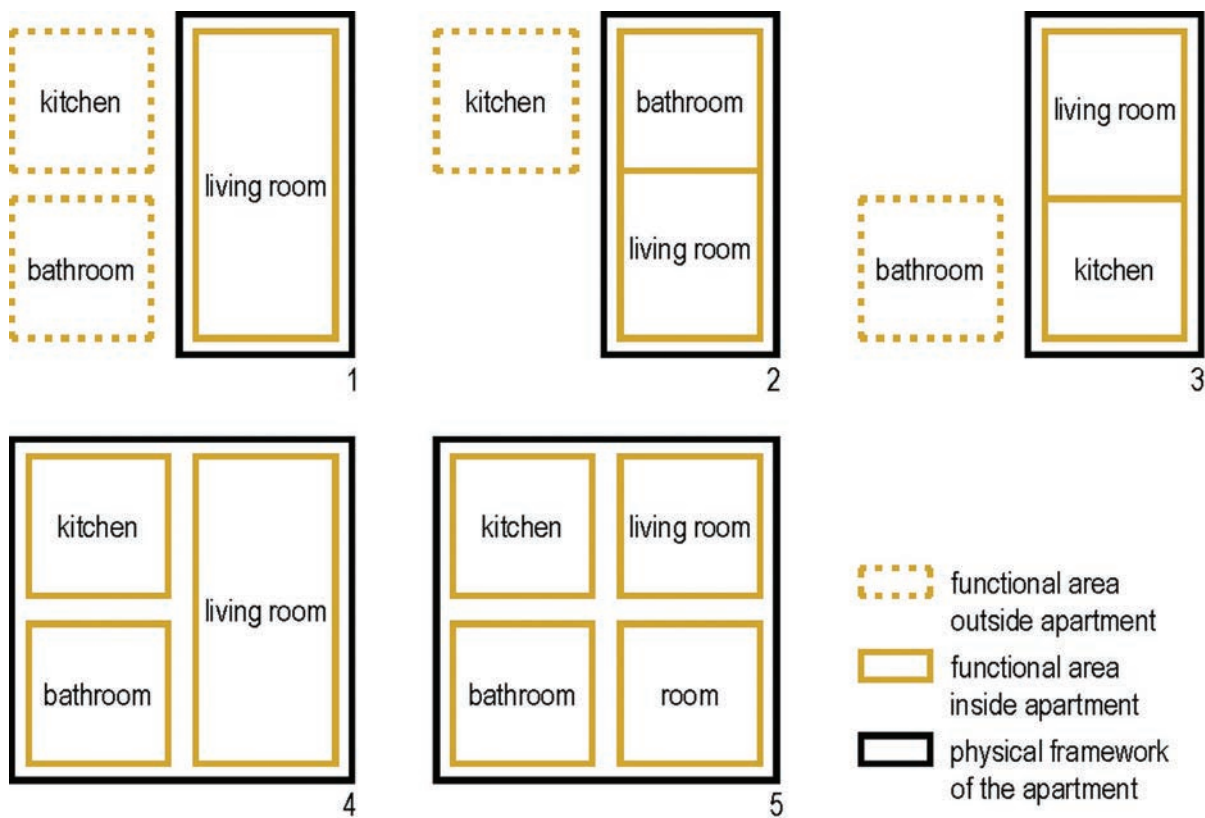
Слика 9. Типологија микро станова према структури простора: 1) Тип 1 - [ДБ] + Кх + Кп, 2) Тип 2 - [ДБ + Кп] + Кх, 3) Тип 3 - [ДБ + Кх] + Кп, 4) Тип 4 - [ДБ + Кп + Кх], 5) Тип 5 - [ДБ + Кп + Кх + СС] (Извор: Alfrević, Simonović Alfrević, Typology of Micro Apartments Based on the Structure of Living Space , 448.)
